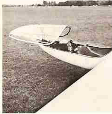
◀ Die verzerrungsfreie Haube geöffnet. The distortion-free canopy, open.
